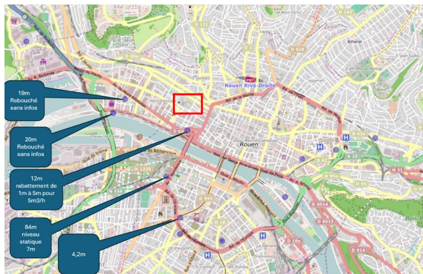
Installations existantes de géothermie sur nappe
